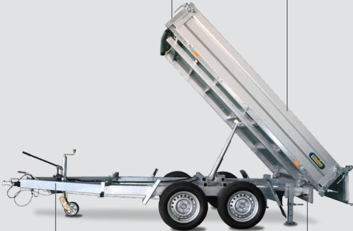
Hydraulische Kippeinrichtung mit Handpumpe und leistungsstarkem Hydraulikzylinder für ein leichtes Abkippen des Transportgutes.
