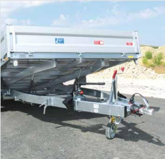
verschweißter und feuerverzinkter Stahlrahmen
