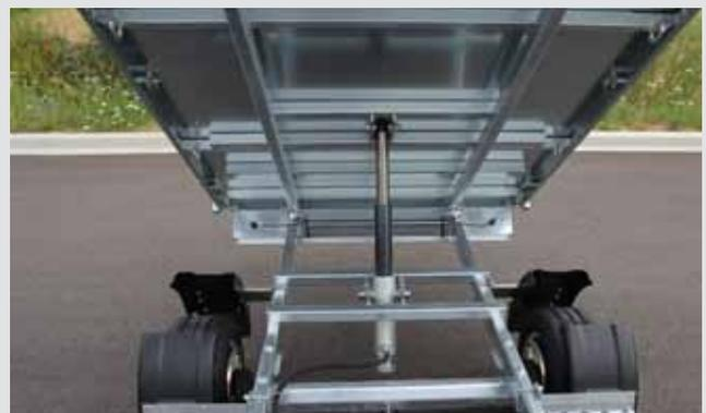
stabile und verschweißte Rahmenkonstruktion
