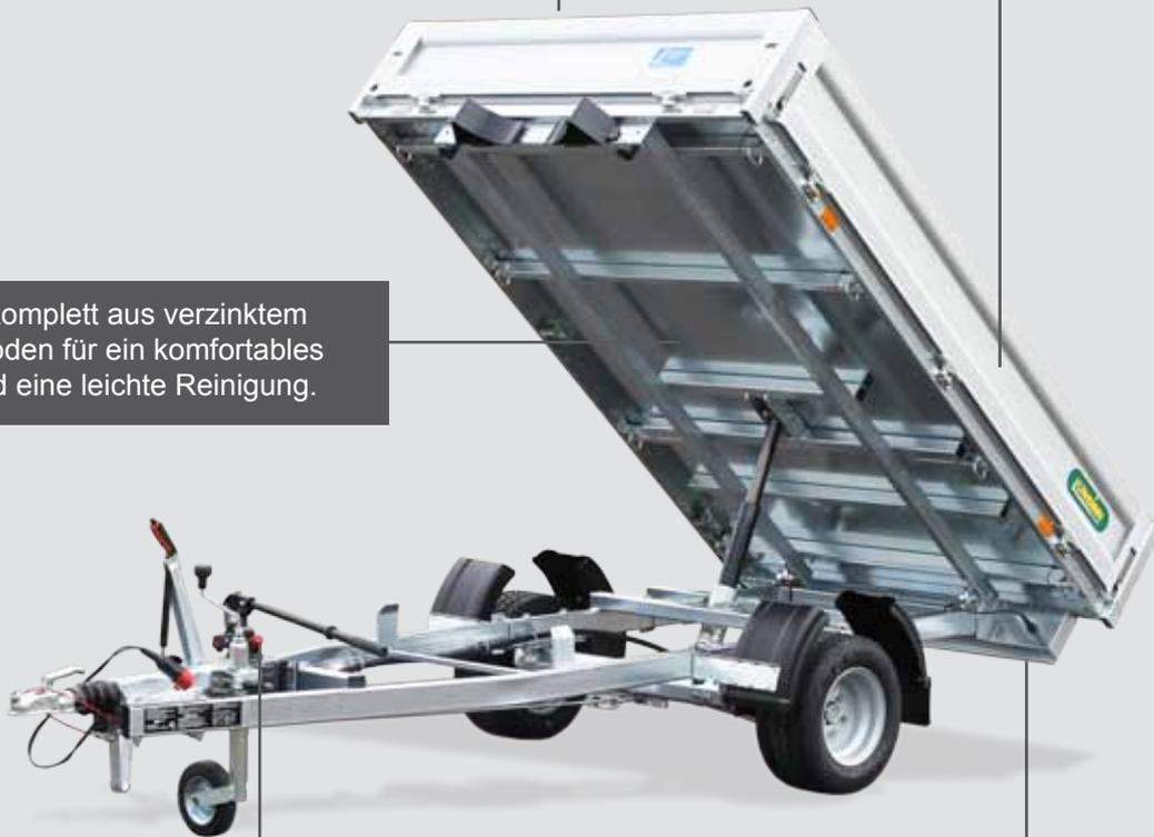
Hydraulische Kippeinrichtung mit Handpumpe und leistungsstarkem Hydraulikzylinder für ein leichtes Abkippen des Transportgutes.
