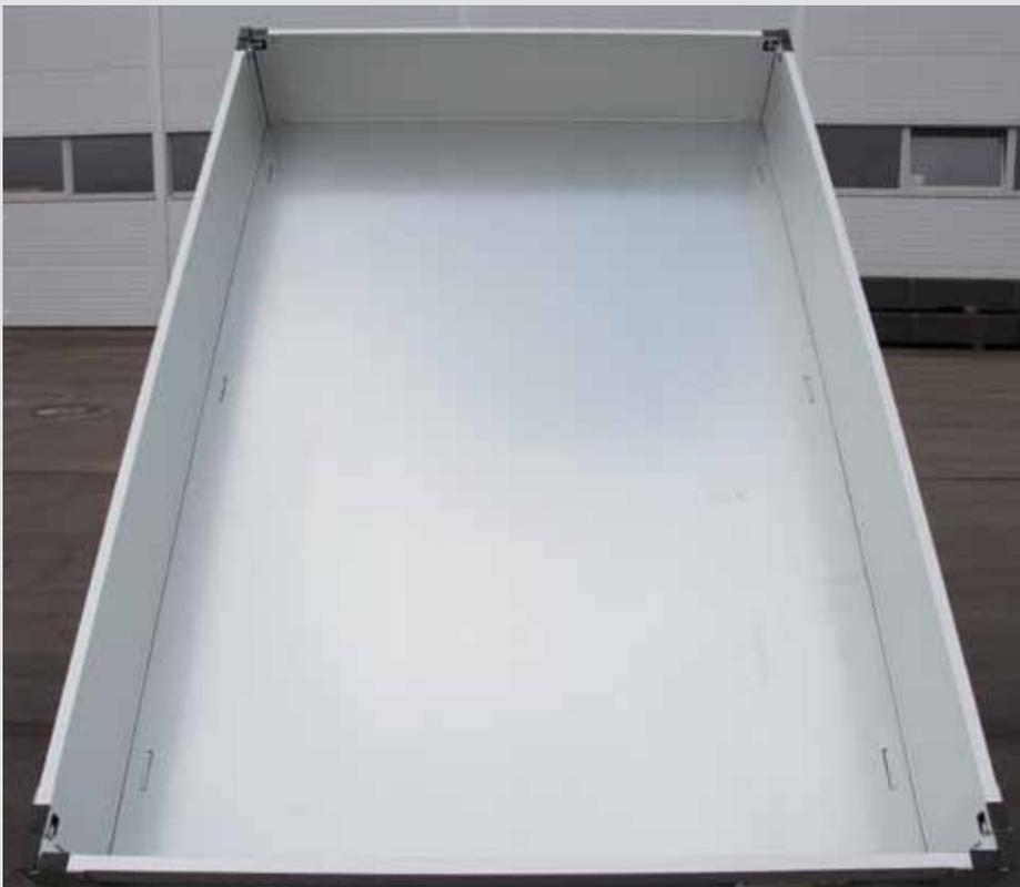
Stahlboden mit versenkten Zurringen
