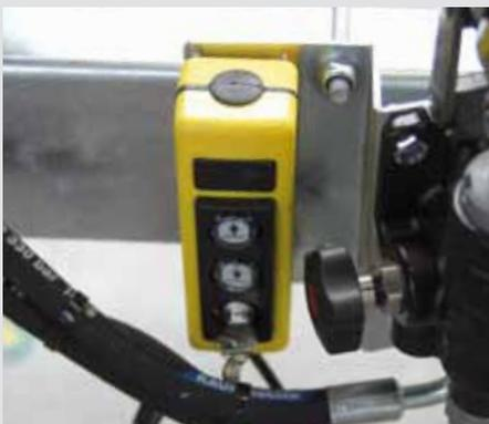
Bedieneinheit E-Hydraulik absperbar
