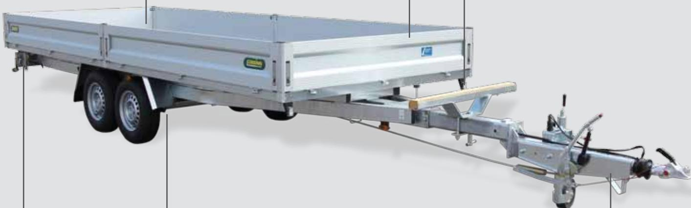
Hochwertige Achs- und Bremskomponenten von namhaften Herstellern. Automatische Nachstellung der Bremse für ein sicheres Fahrverhalten und einen kürzeren Bremsweg.
