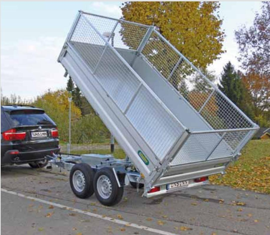
Welldrahtgitteraufsatz (4-seitig pendelnd gelagert)
