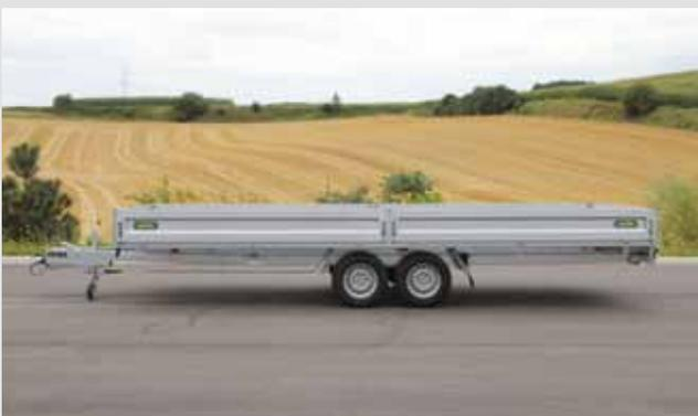
Bordwände mit Mittelrungen (ab Innenlänge 5460 mm)
