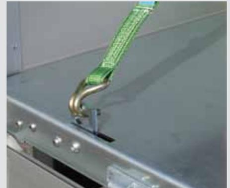
versenkte Zurrringe (Stahlboden)
