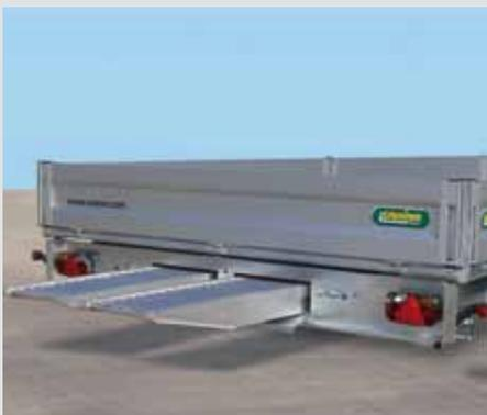
Auffahrschienen mit Halterung unter der Ladefläche
