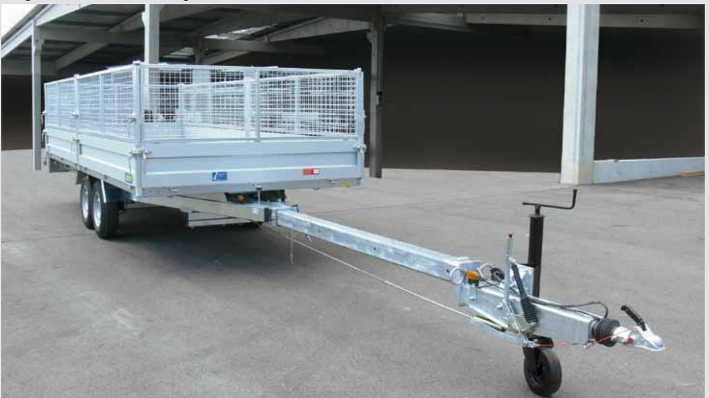
Welldrahtgitteraufsatz und Zugdeichsel in Sonderlänge
