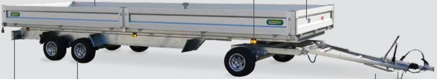
Fahrwerksausführungen mit 2, 3 oder 4 Achsen. Hochwertige Achs- und Bremskomponenten von namhaften Herstellern. Automatische Nachstellung der Bremse für ein sicheres Fahrverhalten und einen kürzeren Bremsweg.
