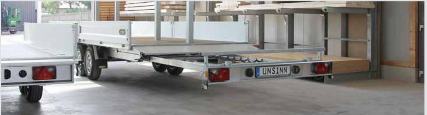
Heckleuchenträger bis 2000 mm ausziehbar und bis 200kg belastbar
