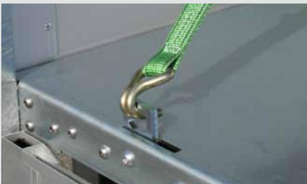
versenkte Zurringe im Stahlboden
