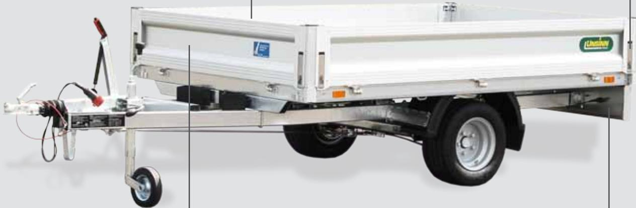
Komplett abklapp- und abnehmbare Alu-Bordwände für vielseitige Beladungsmöglichkeiten.
