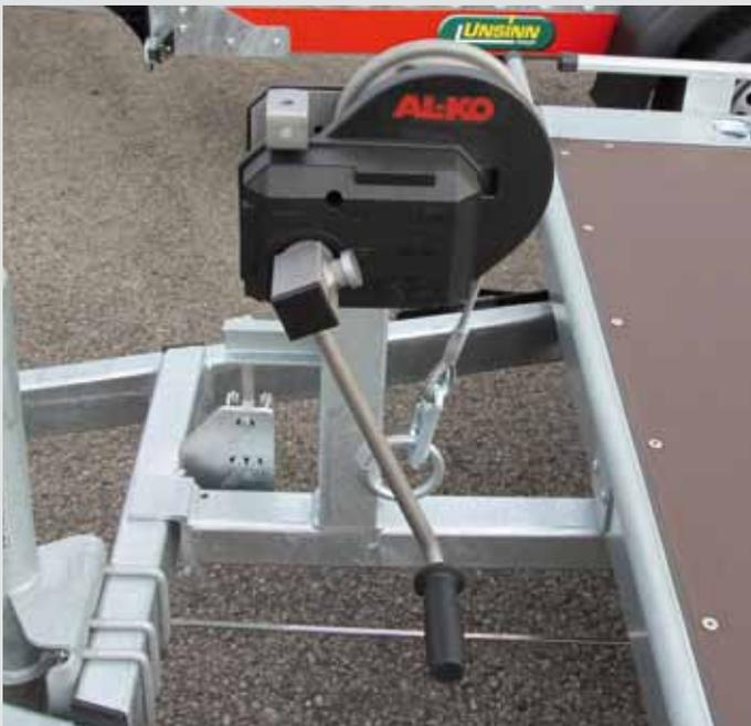
Seilwinde auf Windenbock montiert
