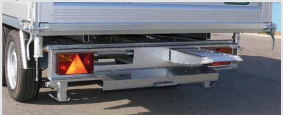
ausziehbare Auffahrschienen mit Spanneinrichtung unter der Ladefläche
