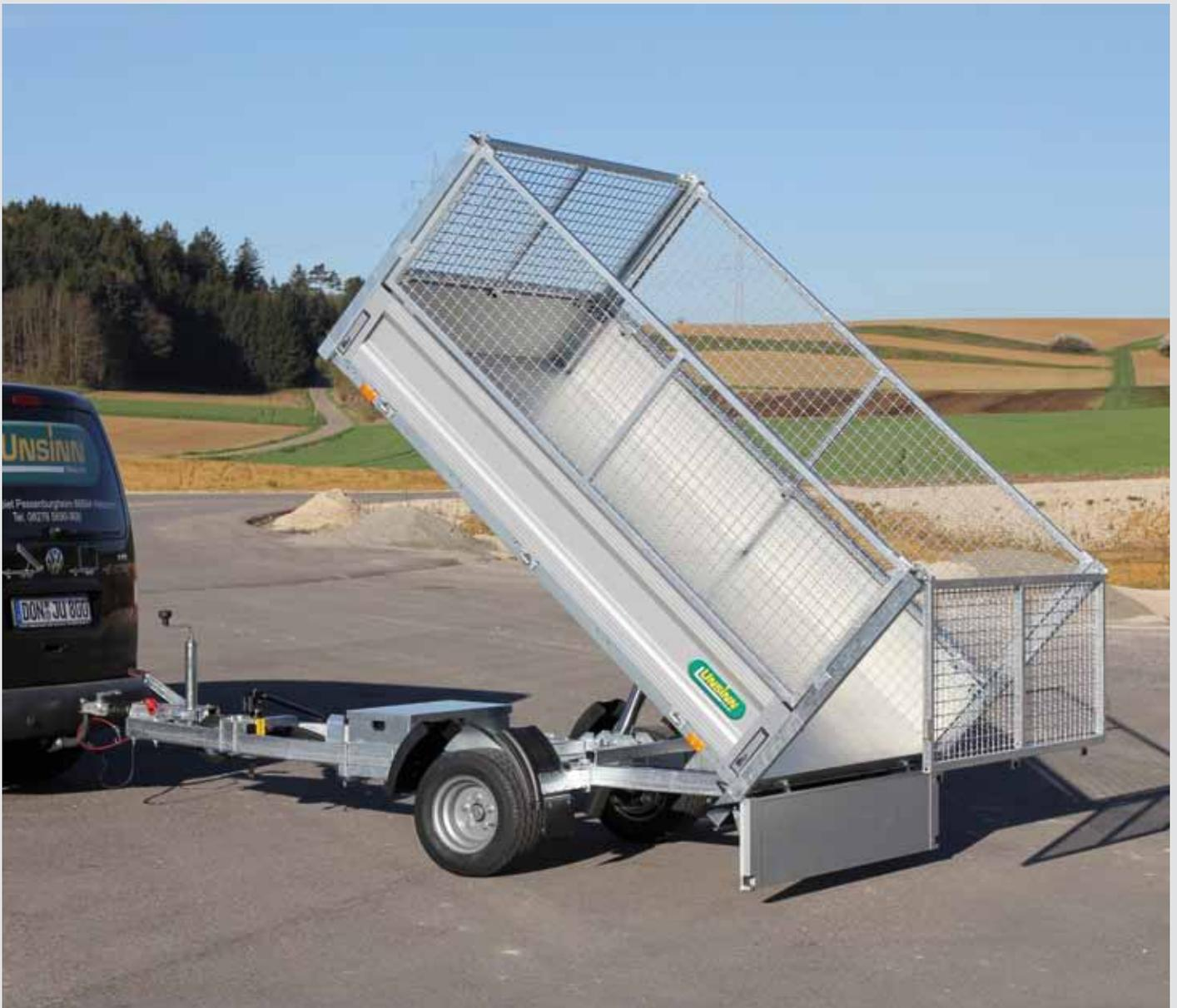
Welldrahtgitteraufsatz (4-seitig pendelnd gelagert)
