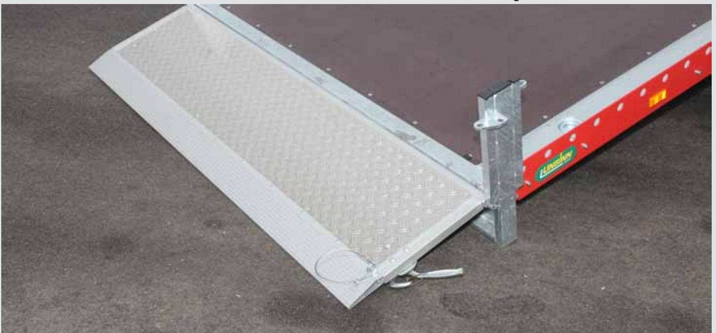
durchgehende Auffahrklappe mit rutschhemmendem Riffelblech
