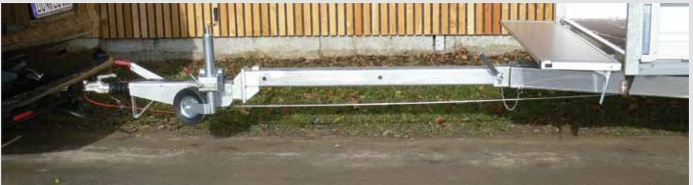
Zugdeichsel ausziehbar (ohne Werkzeug)
