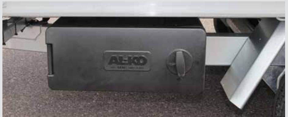
Werkzeugkasten unter der Ladefläche montiert
