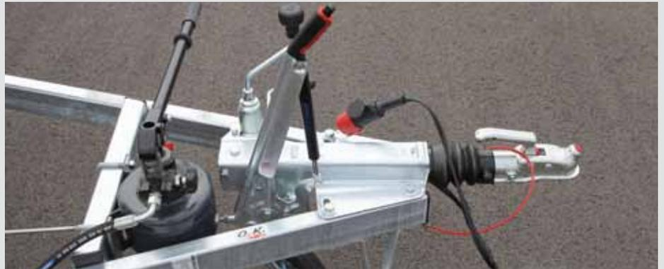
Handpumpe mit hydraulischer Kippeinrichtung
