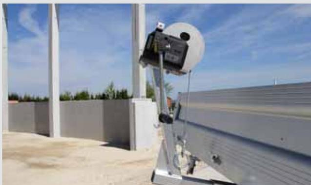
Seilwinde auf geschweißten Windenbock
