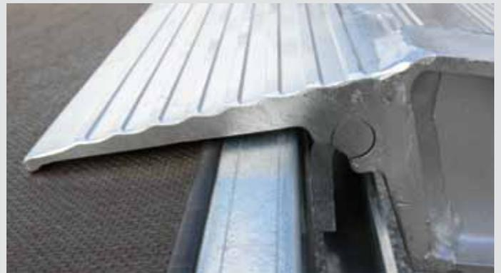
Abrutschsicherung für Auffahrstschienen
