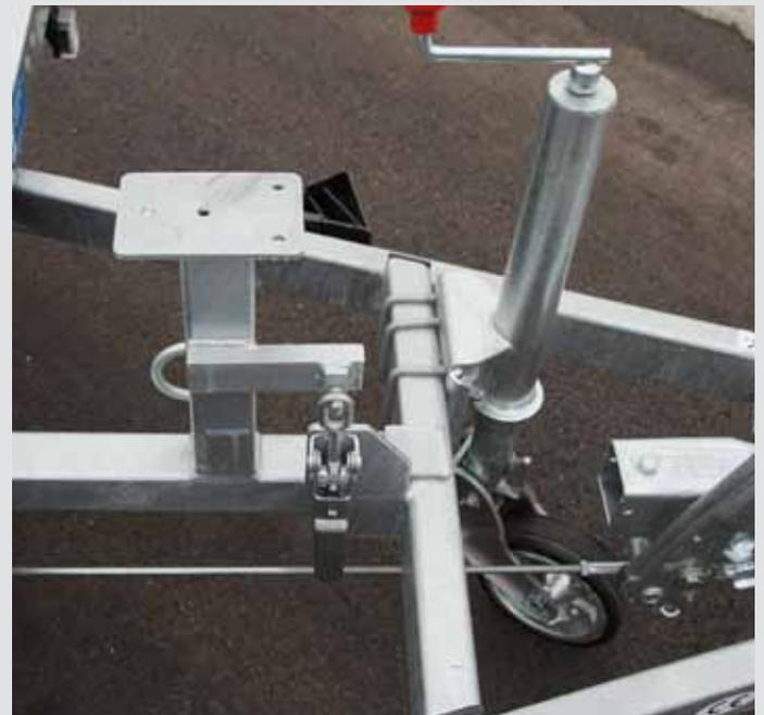
Windenbock mit Sicherungshebel
