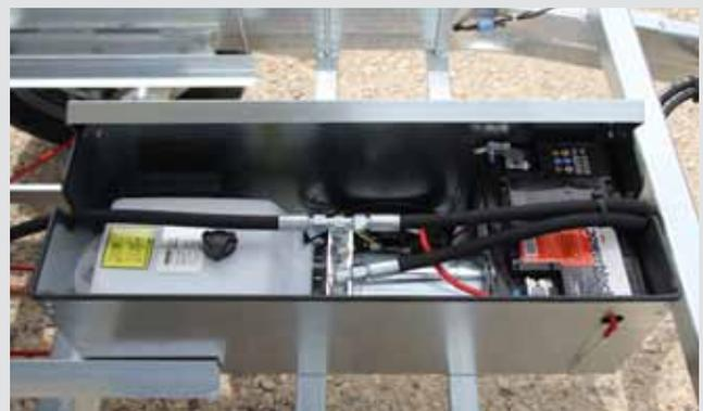
leistungsstarke E-Hydraulik mit hochwertigem Erhaltungs-ladegerät
