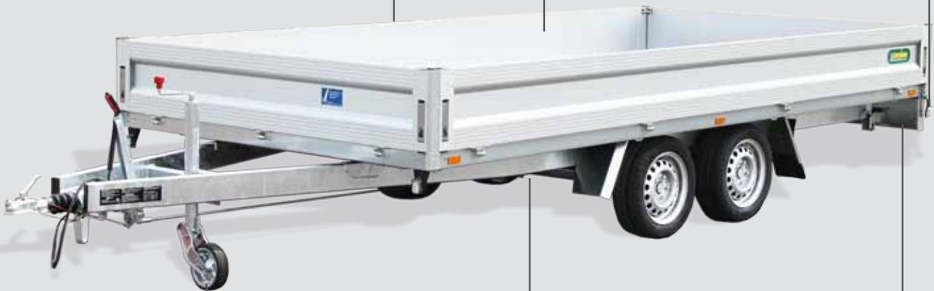
Stabiles Automatikstützrad (500 kg) an geschweißter Stützradtraverse, innenliegend montiert für sicheres Abstellen und leichtes Rangieren.
