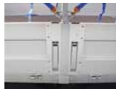
Geteilte Bordwände mit abnehmbaren Mittelpfosten
