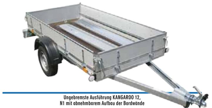
Ungebremste Ausführung KANGAROO 12, N1 mit abnehmbarem Aufbau der Bordwände
