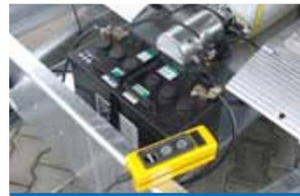
Elektrische Bedienung der Hydraulik
