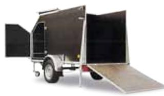
Gebremster Anhänger für Heißluftballon mit Heckrampe und abnehmbarem Dach
