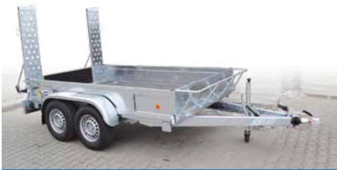
Hinten integrierte Stahl-Auffahrschienen mit hoher Tragfähigkeit
