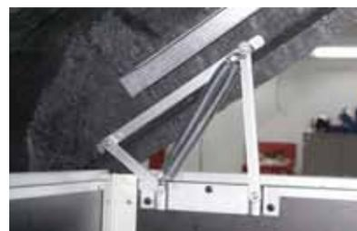
Einfaches System der Deckelöffnung
