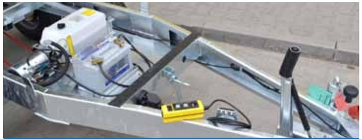
Elektrische Betätigung der Hydraulikanlage mit abnehmbarer Fernbedienung
