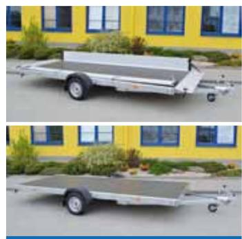
einfache Demontage der Bordwände, Ausführung Plateau
