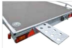
Abnehmbare Auffahrschienen und Schienenschacht unter dem Boden
