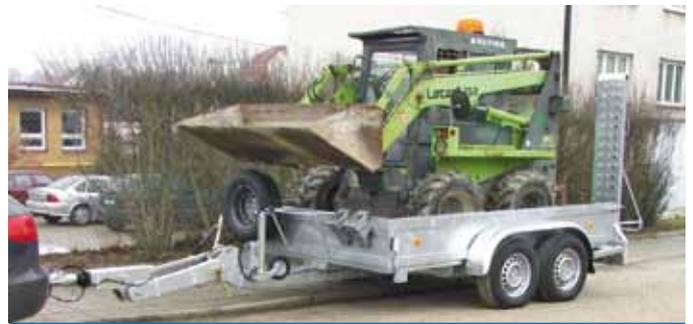
Hinten integrierte Stahl-Auffahrschienen mit hoher Tragfähigkeit
