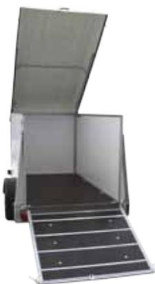
Hintere Rampe mit Möglichkeit der antirutsch Ausführung
