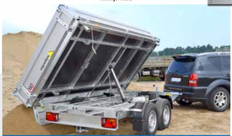
Geschweißter oberer und unterer Rahmen mit Hydraulik
