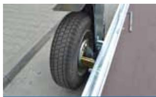
Hydraulisch absenkbare Achse
