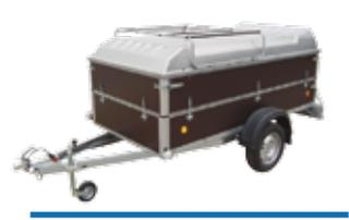
Anhänger VZ 26 mit Bordwandaufsatz und GFK Deckel
