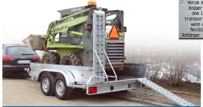
Hintere integrierte Stahl-Auffahrschienen mit hoher Tragfähigkeit
